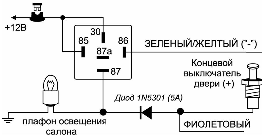
5) ЗЕЛЕНый/ЖЕЛТый провод может быть также запрограммирован как **“отрицательный выход для отпирания всех дверей”** для реализации функции отпирания дверей в 2 этапа при снятии системы с охраны.
